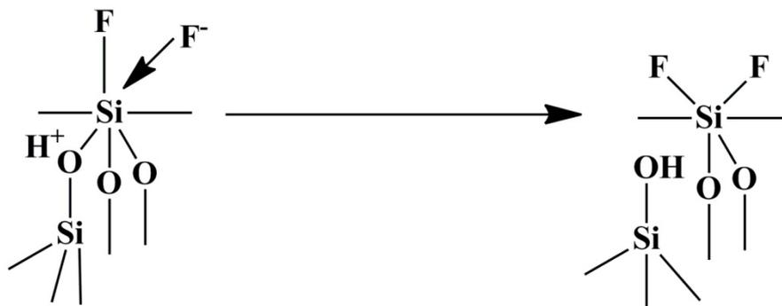
**Рисунок 76 - Схема взаимодействия базальтовых волокон с 0.5 М раствором HF.**
