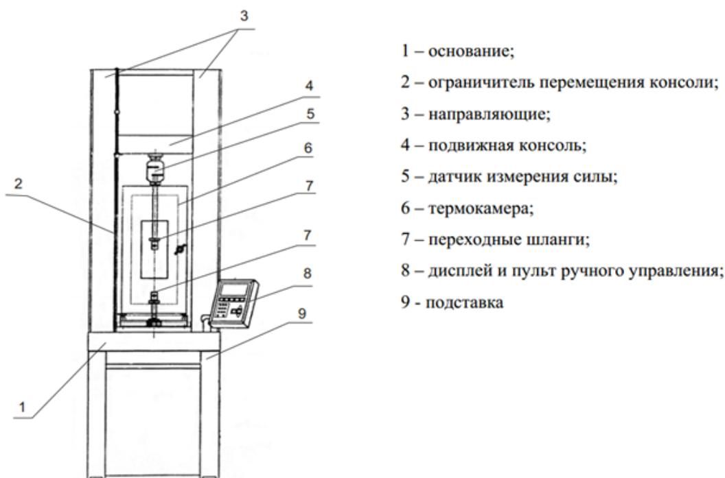
**Рисунок 8 - Схема универсальной испытательной машины Hounsfield H5KS.**
