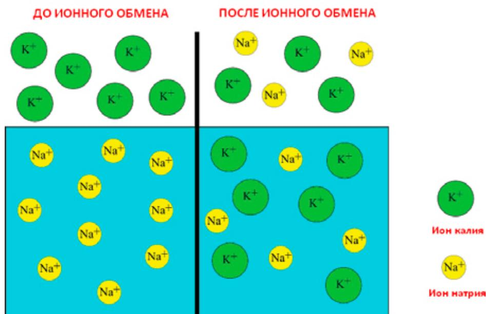
Рисунок 29 - Схема ионного обмена в поверхностном слое базальтовых волокон [53].
