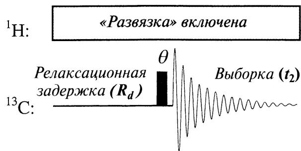
Рис. 6.1. Схема стандартного эксперимента ^{13}\text{C}\{-^1\text{H}\} -ЯМР с «широкополосной развязкой» от протонов.
