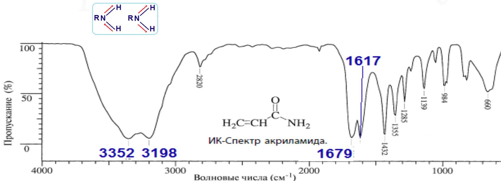
Валентные колебания N-H первичного амида, связанной водородными связями: антисимметричные  $3352 \text{ см}^{-1}$ , симметричные  $3198 \text{ см}^{-1}$ ; перекрывание валентного колебания C=O и полосы Амид I:  $1679 \text{ см}^{-1}$  (см. табл. 2.6); деформационное колебание N-H (полоса Амид II):  $1617 \text{ см}^{-1}$ ; валентное колебание C-N:  $1432 \text{ см}^{-1}$ ; широкая полоса деформационного внеплоскостного колебания N-H:  $700\text{--}600 \text{ см}^{-1}$
