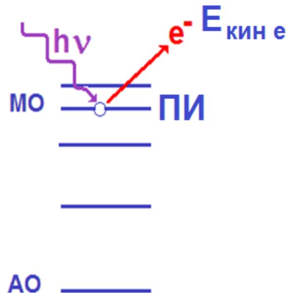
Схематическое сопоставление различных типов электронной спектроскопии (МО и АО, соответственно, обозначены молекулярные и атомные орбитали):
