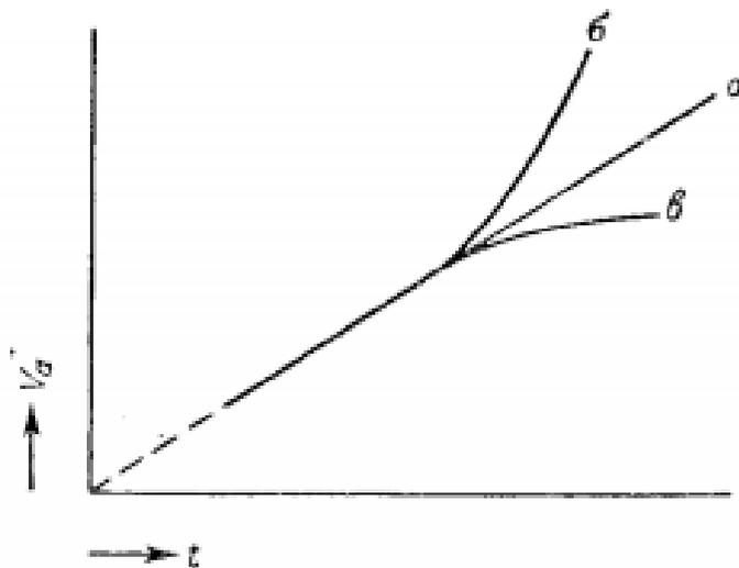
Три основных типа графиков зависимости общего объема адсорбированного вещества от толщины адсорбционного слоя.
