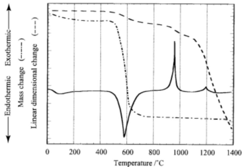
20. При термоциклировании мелкодисперсных смесей  $\text{BaCl}_2 + \text{KNO}_3$  в молярном соотношении 1:2 ( $2^\circ/\text{мин}$ , платиновые тигли) было установлено, что первый и второй нагрев выглядят абсолютно по-разному. Объясните причину этого явления, и дайте характеристику каждому пику на кривой ДСК
