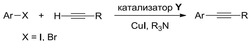
В качестве катализатора Соногашира использовал комплекс **Y**, полученный из коммерчески доступной соли **Z** и трифенилфосфина. Соль **Z** получают совместной кристаллизацией из водного раствора двух галогенидов **Q** и **R**. Из-
