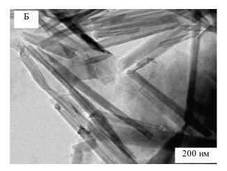
Рис. 1. Электронно-микроскопические снимки исходных монтмориллонитов Таганского месторождения:
