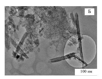
Рис. 4. Электронно-микроскопические снимки монтмориллонитов Таганского месторождения, обработанных соляной кислотой:  $A-CaM,\ B-NaM$
