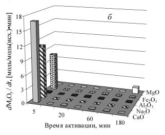
Рис. 3. Кинетические результаты извлечения катионов металлов при кислотной активации (2,9 M HCl) монтмориллонитов:  $a - \mathrm{CaM}, \ \delta - \mathrm{NaM}$
