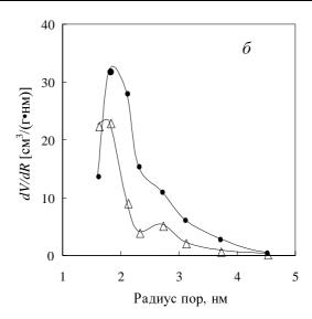
Рис. 5. Дифференциальные кривые распределения пор в исходных компонентах и композиционных наноматериалах:
