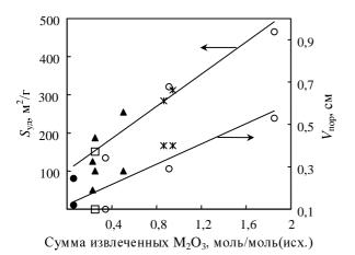
Рис. 2. Зависимость удельной поверхности и удельного объема пор (на примере натриевого монтмориллонита) от общего количества удаляемых при кислотной обработке катионов  $Al^{3+}$ ,  $Fe^{3+}$ :
