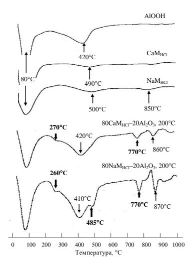
Puc. 6. Термограммы исходных компонентов и композиционных наноматериалов состава  $80\text{CaM}_{HCl}\text{-}20\text{Al}_2\text{O}_3$  и  $80\text{NaM}_{HCl}\text{-}20\text{Al}_2\text{O}_3$
