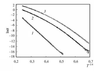
Рис. 2. Зависимость логарифма электропроводности от температуры в степени -1/4.
