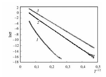
Рис. 3. Зависимость логарифма электропроводности от температуры в степени -1/2.
