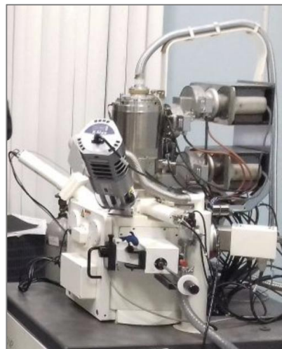
Растровый электронный микроскоп LEO Supra VP + Oxford EDX and WDX
