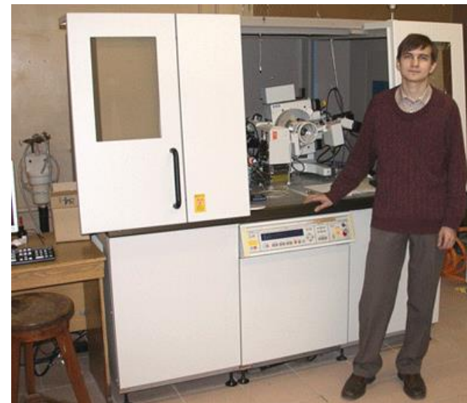
Дифрактометр Rigaku 3DMax 18KW
