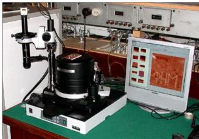
Сканирующий зондовый микроскоп Integra Aura SPM complex
