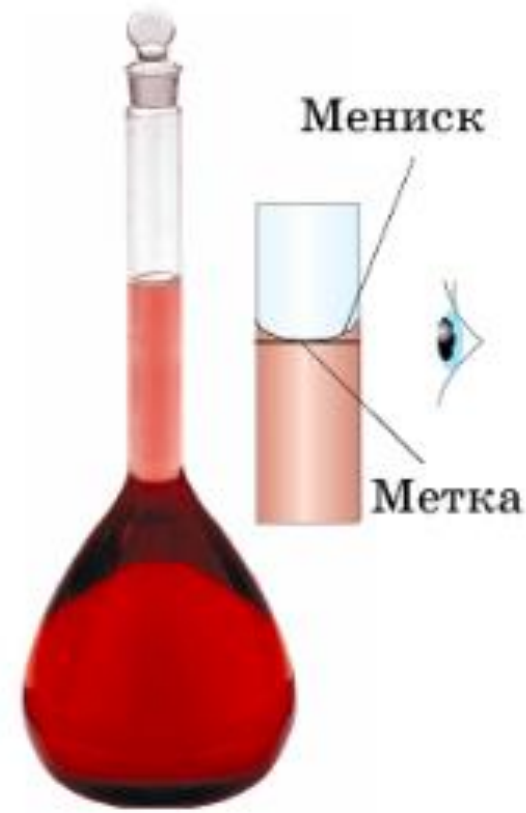
Рис. 20. Приготовление раствора в мерной колбе
