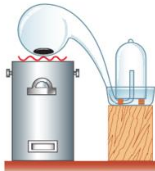
Рис. 53. Опыт Лавуазье по определению состава воздуха
