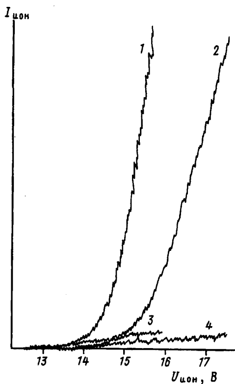
Кривые эффективности ионизации для ионов: 1 – B_2O_3^+ + фон, 2 – B_2O_2^+ + фон, 3, 4 – фон
