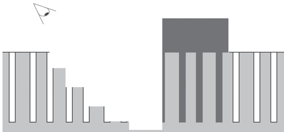
Рис. 1. Схема определения глубины отверстий в алюминии методом ионной резки с защитным слоем. Серым показан алюминий, черным – защитный платиновый слой
