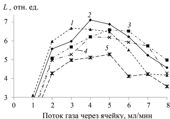
Рис. 1. Зависимость соотношения сигнал/фон кальция от скорости потока гелия через ячейку при разных значениях SST Bias и Pole Bias: 1 – (–21,5; –17,5), 2 – (–20,5; –18,5), 3 – (–20; –19), 4 – (–21; –18), 5 – (–22; –17) (первое значение в скобках – SST Bias, второе – Pole Bias)
