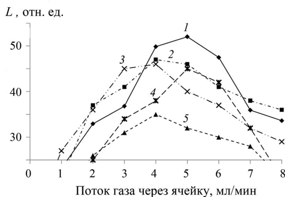
Рис. 2. Зависимость соотношения сигнал/фон кремния от скорости потока гелия через ячейку при разных значениях CСТ Bias и Pole Bias: 1 – (-22; -17), 2 – (-21; -18), 3 – (-21,5; -17,5), 4 – (-20,5; -18,5), 5 – (-20; -19) (первое значение в скобках – CСТ Bias, второе – Pole Bias)
