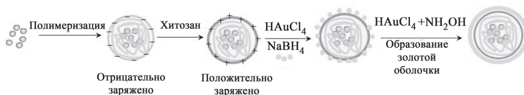
Рис. 8 Схема синтеза наночастиц магнетит-золото с использованием полимерной матрицы
