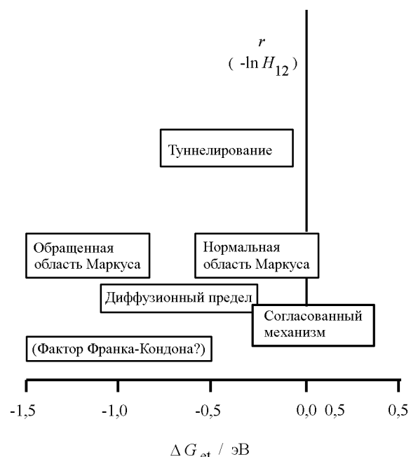
Рис. 6. Механизмы переноса электрона в зависимости от расстояния r между реагентами (и H_{12} \sim \exp(-r) ) и движущей силы переноса электрона \Delta G_{\text{et}}
