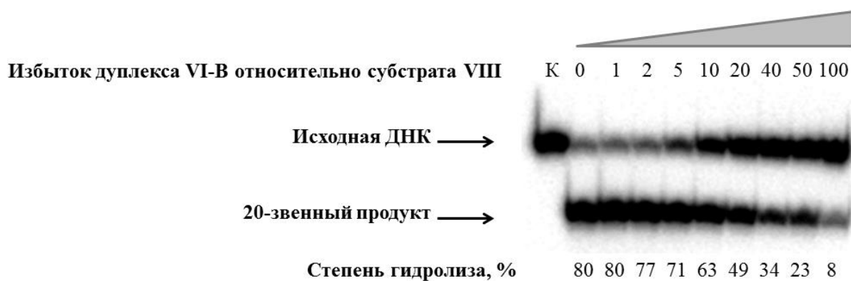
Рис. 2.37. Анализ продуктов гидролиза 30-звенного субстрата VIII Nt.BspD6I в присутствии ДНК-дуплекса VI-B . Радиоавтограф 20%-ного ПААГ с 7 М мочевиной. Условия инкубации – 30 мин при 37°C. Дорожка К – исходная ДНК (меченная 32 P «верхняя» цепь ДНК-дуплекса VIII ), остальные дорожки – реакционные смеси после гидролиза субстрата VIII (10 нМ) Nt.BspD6I (10 нМ) в присутствии дуплекса VI-B (концентрацию варьировали от 0 до 1 мМ).
