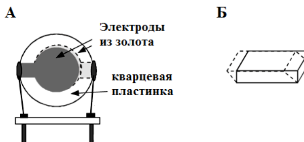
Рис. 2.19. Пьезоэлектрический резонатор – кристалл кварца АТ-среза, на котором с двух сторон закреплены золотые электроды. А: фотография резонатора. Б: схематическое изображение колебаний по толщине.
