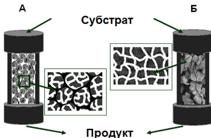
Рисунок 13 – Схема, иллюстрирующая движение вещества в упакованных частицами колонках (А) и в монолитных матрицах (Б).
