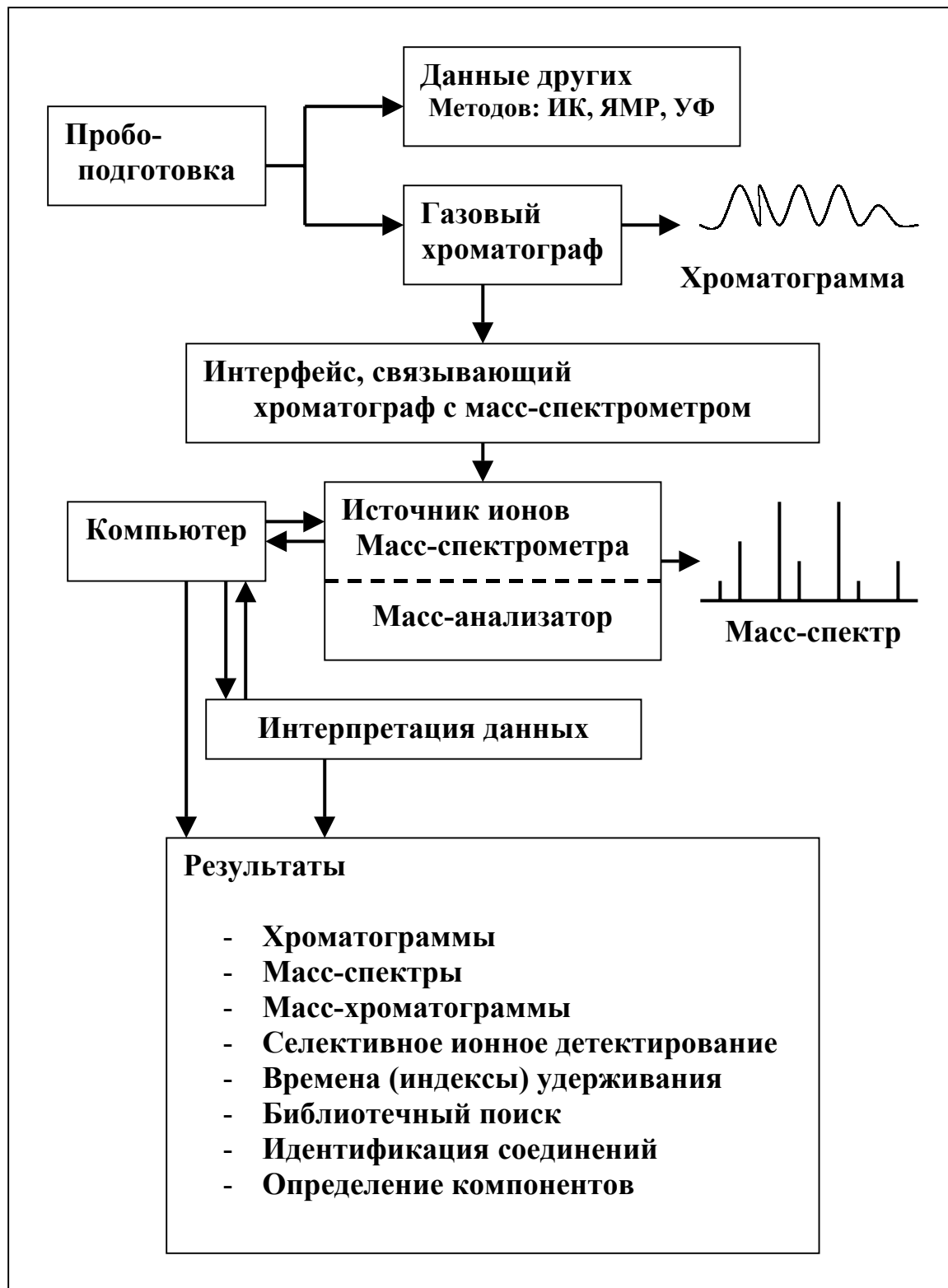
Рис.12. Основные элементы системы: газовый хроматограф – масс-спектрометр – компьютер
